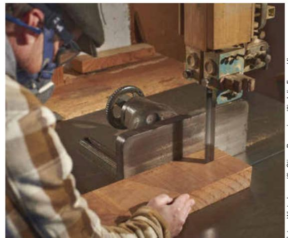
Die Bandsäge mit 70 cm Schnitthöhe – sie ist elementar für die Möbelfertigung der Winterhagers
