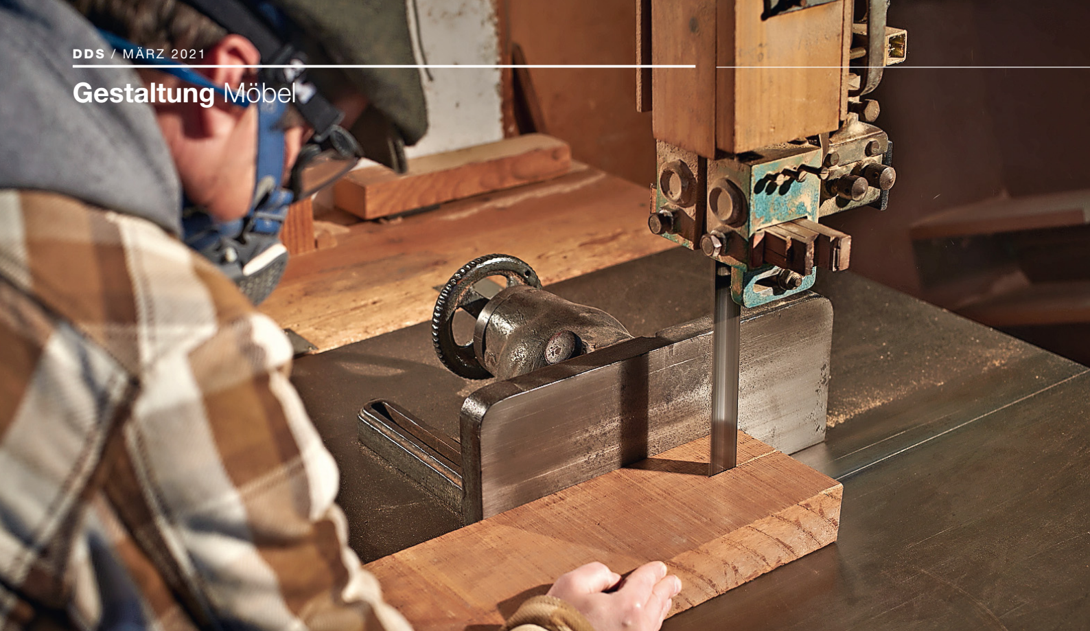
Ein Herzstück der Tischlerei ist die robuste Bandsäge mit nahezu 70 cm Schnitthöhe, mit der die Winterhagers nicht nur Balken zu Tischbohlen auftrennen, sondern Möbeln auch eine ganz eigene Oberflächenstruktur verleihen
